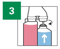
Richten Sie die Wasserflasche so aus, dass sich die abgeflachten Seiten der Flaschen gegenüber befinden und schieben Sie die Wasserflasche in die zweite Öffnung des Sprühkopfes (langes Steigrohr). Durch Schieben des Hebels arretieren Sie die Wasserflasche am Sprühkopf.
