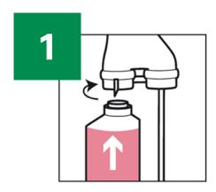
Setzen Sie die Flasche mit der Reinigungschemie in die hintere Öffnung (kurzes Steigrohr) des Sprühkopfes und schieben Sie den Hebel fest zu. Die Reinigungslösung ist nun fest arretiert und kann nicht auslaufen.
